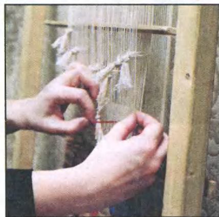
Фото 3. Первый зев раскрыт поворотом делительной планки вокруг продольной оси. В зев вложена нить.
