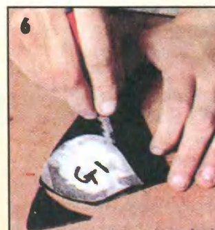
Резку темного стекла производят по наложенному на него шаблону с обводкой стеклорезом контура по возможности в один прием.
