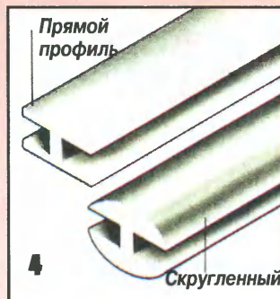
При монтаже витража применяют перемычки с H-образным профилем, а для его краев требуются П-образные профили.
