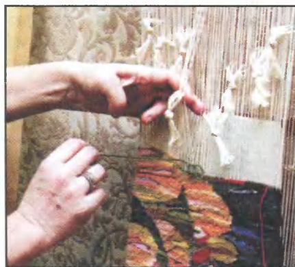
Фото 6. В раскрытый второй зев прокладываем нить утка.
