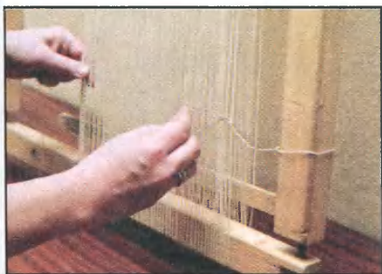
Фото 1. Основа заправлена. Начало вязки «косички» (разборка нитей основы на пары).
